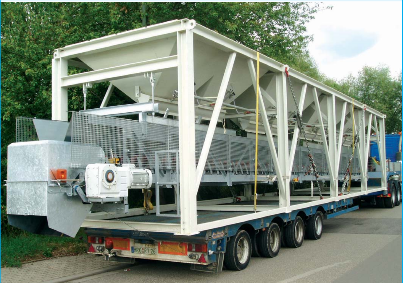
MIXOMAT THZ 3000 B - R 4 / 4 Reihensiloanlage, Verladung des Silounterteils • MIXOMAT THZ 3000 B - R 4 / 4 aggregate in-line silo system, loading of a silo module
