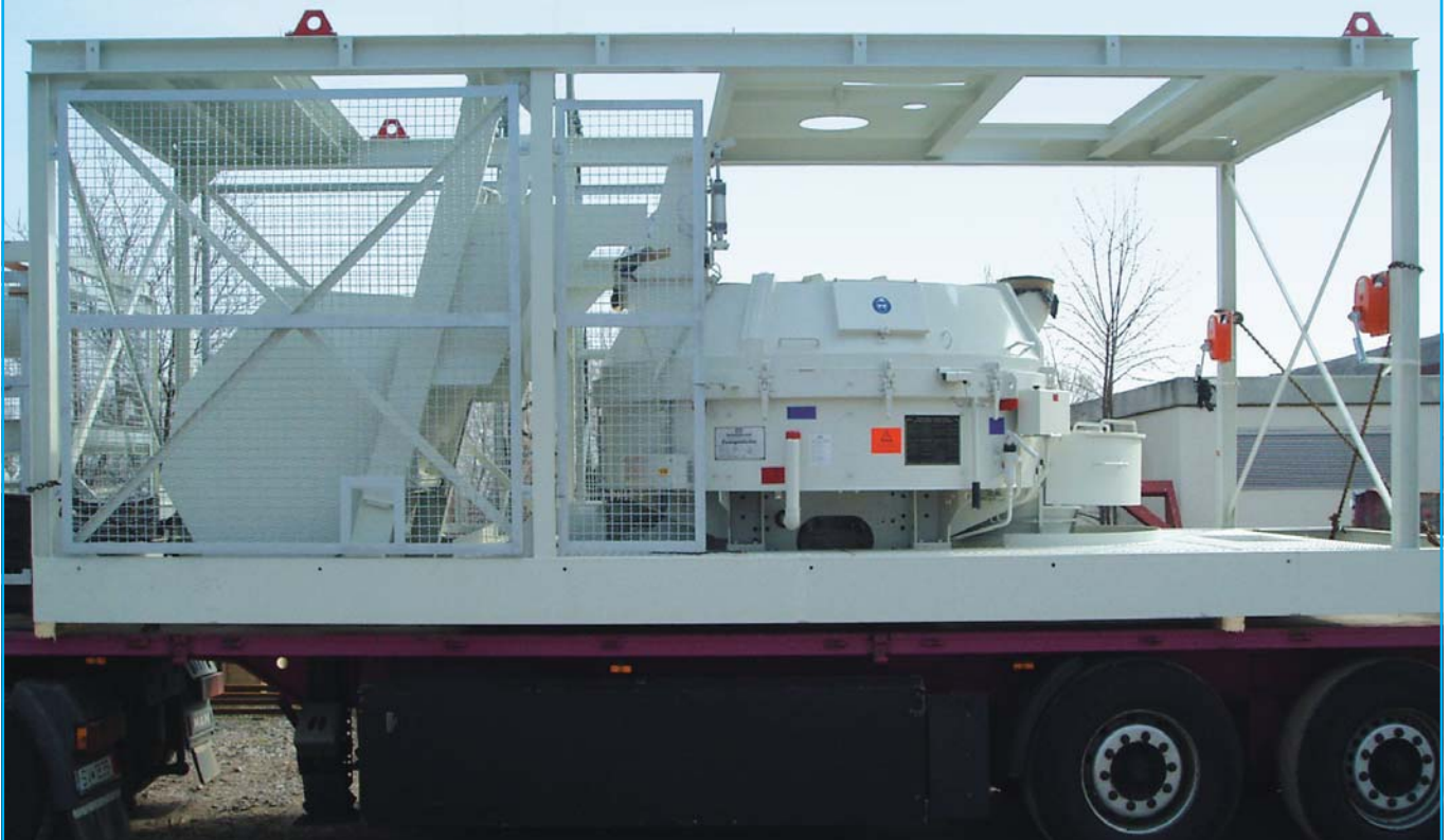
MIXOMAT THZ 1500 B - R Reihensiloanlage, Verladung des Mischer-Moduls • MIXOMAT THZ 1500 B - R aggregate in-line silo system, loading of a mixer module
