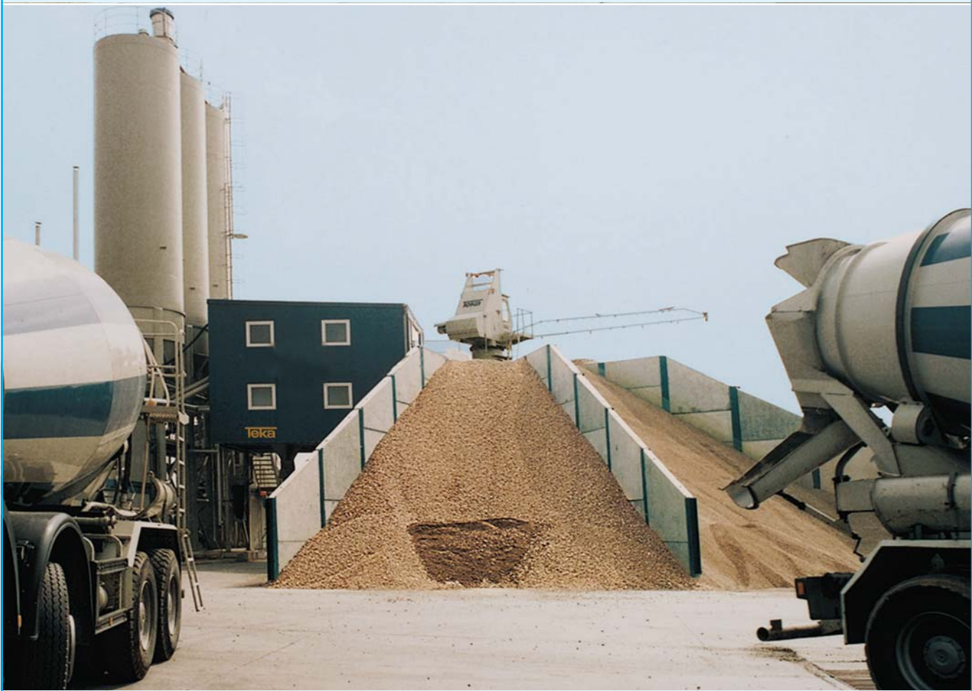
MIXOMAT THZ 3000 B - S 6 Sternanlage mit vollautomatischem Schrapppwerk THS 60/22 • MIXOMAT THZ 3000 B - S 6 scraper system with fully-automatic scraper THS 60/22
