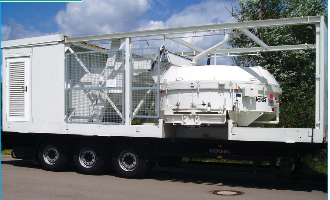
MIXOMAT THZ 3000 C - R Reihen-Siloanlage, Verladung des Mischer-Moduls • MIXOMAT THZ 3000 C - R aggregate in-line silo system, loading of a mixer module
